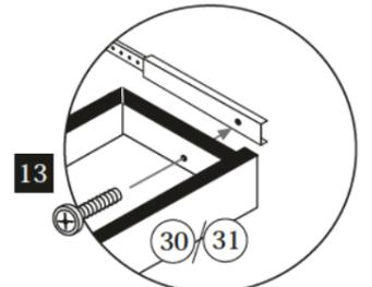
Die Metallauflisten ganz ausziehen, den Schubkasten dazwischen schieben und mit der Schraube links und rechts fixieren.
